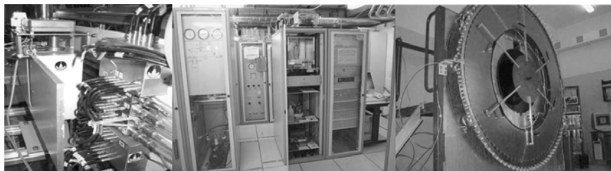
Рис.3. Элементы газовой системы ТДПИ с символикой МГУ (слева), блоки регуляции газовой системы (в центре) и торцевой модуль ТДПИ из дрейфовых трубок (диаметр трубок 4 мм, диаметр модуля 2м, справа)
