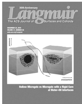
Рис. 2. Результаты компьютерного моделирования адсорбции различных частиц микрогеля на межфазной границе двух жидкостей
