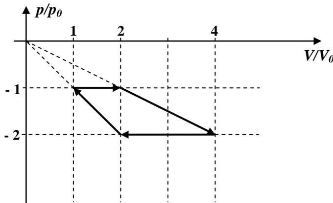
Как видно по направлению обхода, это действительно цикл тепловой машины, причем вещество получает тепло в процессе изотермического сжатия, и отдает в процессе изотермического расширения. Поэтому (работу цикла удобно вычислять как площадь трапеции):
