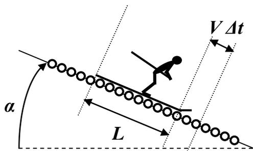
При скатывании без проскальзывания лыжи «раскручивают» ролики, поэтому кинетическая энергия системы состоит из энергии поступательного движения лыжника с лыжами и энергии вращательного движения роликов, то есть
