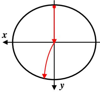
Со стороны магнитного поля на частицу действует сила Лоренца, сообщающая ей горизонтальное ускорение
