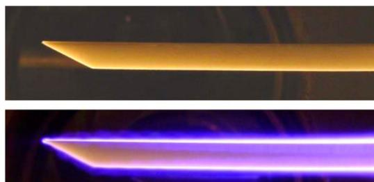
Рис. 1. Общий вид поверхностного СВЧ-разряда при средних давлениях воздуха.
