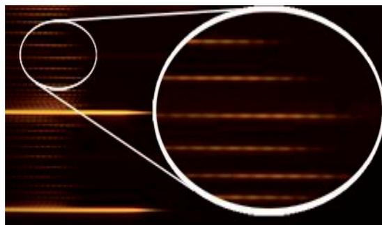
Рис. 2 Люминесценция периодической структура из центров окраски, наведенных одиночной световой пулей в LiF при филаментации импульса на длине волны 3100 нм, длительностью 100 фс, энергией 15 мкДж. Период структуры 30 мкм. Подсветка на длине волны 450 нм.
