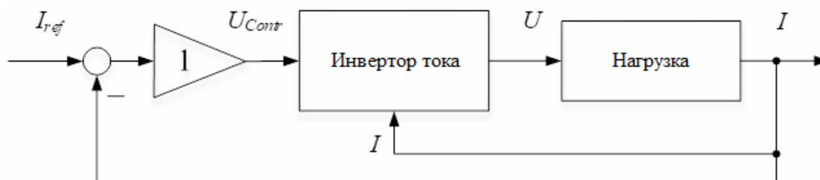
Рис. 2. Схема замкнутой системы для идентификации.
