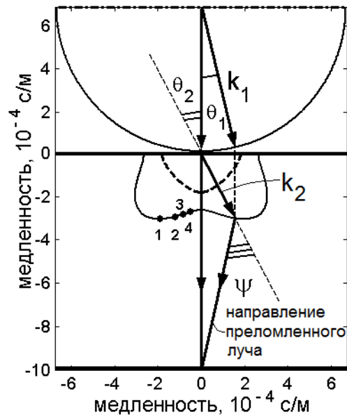
Рис. 7. Поперечное сечение поверхностей акустической медленности для образца и иммерсионной жидкости
