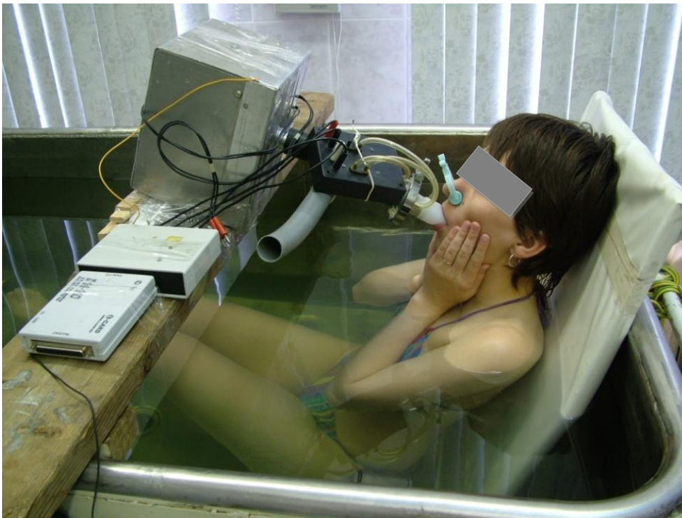
Рис. 9. Измерение импеданса системы дыхания методом вынужденных колебаний в условиях водной иммерсии.
