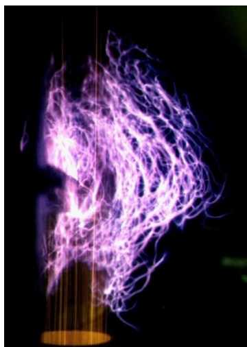
Рис.10. Вид разряда в потоке при давлении в камере 100 Torr и E_0=5.5 kV/см. Сверхзвуковой поток направлен снизу вверх. \lambda=8.9 см
