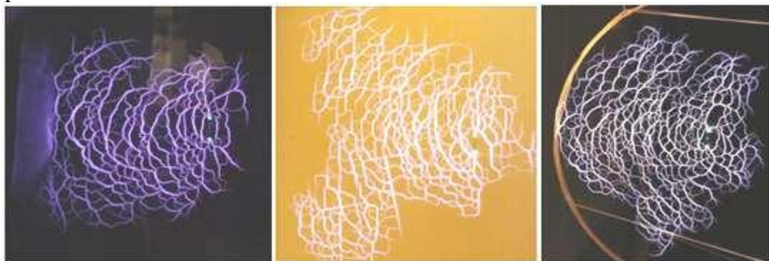
Рис.17. Структурные свойства разряда не зависят от материала и толщины диэлектрической пластины: (а) – полиэтиленовая пленка, 0.02 см толщины, (б) – стеклотекстолит, 0.2 см, (в) – кварцевое стекло, 1.0 см
