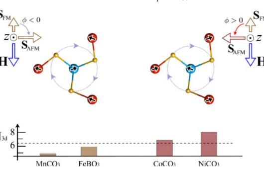
Рис. 4. Иллюстрация взаимных направлений магнитных моментов в случае отрицательного и положительного знаков DMI. Внизу — диаграмма, показывающая эволюцию величины и знака DMI в изучаемой серии соединений 3d элементов.
