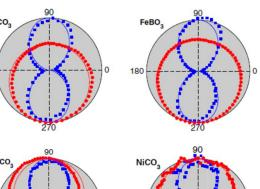
Рис. 3. Зависимость интенсивности брэгговского отражения от угла поворота магнита. Вдали от края поглощения (вне резонанса, синяя кривая) эта зависимость одинакова для всех кристаллов, в резонансе (красная кривая) направление сдвига кривой от центра определяется знаком взаимодействия Дзялошинского-Мории.
