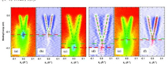
Рис. 3. Энергия связи электронов в (a)  $Bi_2Te_3$ , (c)  $Fe_{0.025}Bi_2Te_3$ , and (e)  $Fe_{0.1}Bi_{2}Te_{3}$  вдоль линии  $\Gamma$ -М. Штриховая линия — подгонка из кривых распределения импульсов электронов. (b), (d), и (f) вторые производные
