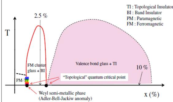
Рис. 4. Фазовая диаграмма и топологические фазовые переходы Fe, Bi, Te,
