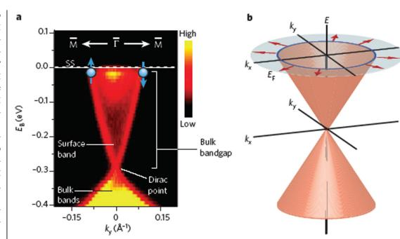
Рис. 2. a — Электронная структура Bi<sub>2</sub>Se<sub>2</sub>, полученная ARPES. показывающая спины электронов с энергией Е при его движении
