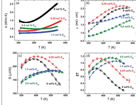
Рис. 6. Температурные зависимости теплопроводности к (а), сопротивления  $\rho$  (b), коэффициента Зеебека S (c) и безразмерной термоэлектрической эффективности ZT (d) нанокомпозитов  $Bi_{0.5}Sb_{1.5}Te_{3}/C_{60}$  при разном
