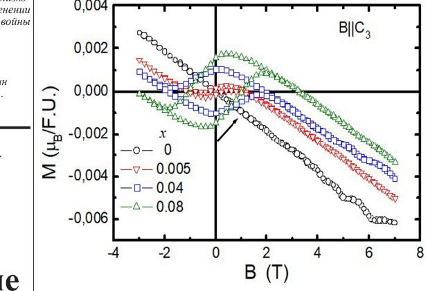
Рис. 1. Зависимость намагниченности M вдоль оси  $C_3$  (перпендикулярно слоям кристалла) от магнитного поля при Т=2 К для образцов Віз\_ Fe, Te,
