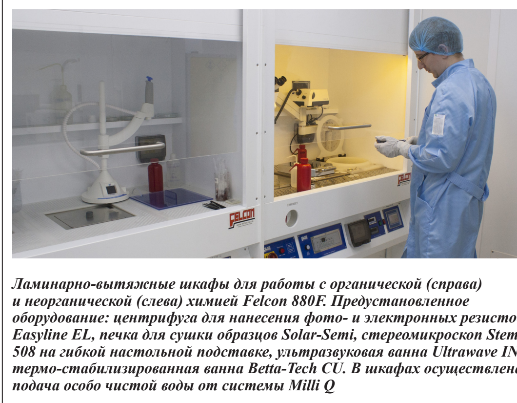
Лампажно-вытяжные шкафы для работы с органической (справа) и неорганической (слева) химией Tecon, оснащенные цифровизацией, оптоэлектронным оборудованием: центрифуга для нанесения фото- и электронных резистов EasyLine LE, печь для сушки образцов Solar-Semi, стереомикроскоп Stemi 508 на подвижной оптической платформе Beta-Tech CU. В шкафах осуществлена подмена особо чистой воды на систему Milli Q
