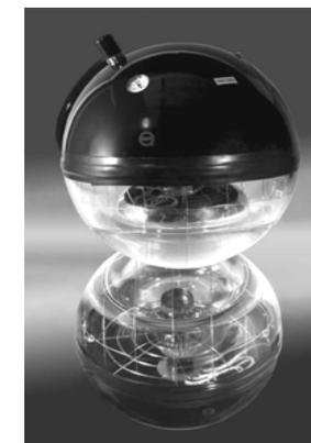
Оптический модуль нейтринного телескопа
