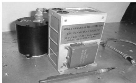
Рис. 1. Общий вид лидара перед отправкой из ИКИ РАН в НАСА с микрофоном в коробке на передней стенке, который разрабатывало «Планетное общество США» совместно с университетом Калифорнии. Ручка на переднем плане для сравнения и оценки реальных размеров лидара
