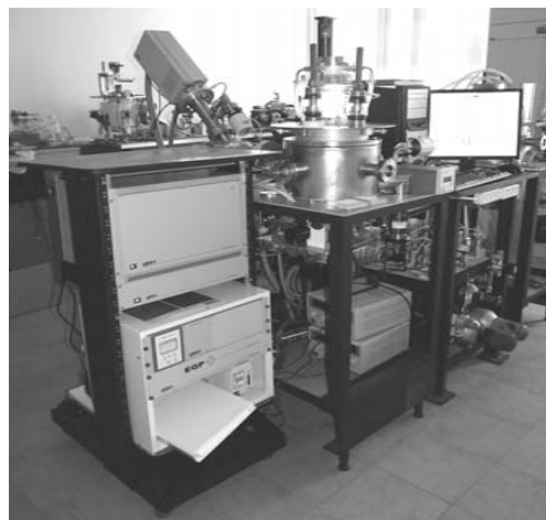
Автоматизированный комплекс для анализа заряженных и нейтральных частиц плазмы на основе квадрупольного масс-спектрометра и анализатора энергий ионов
