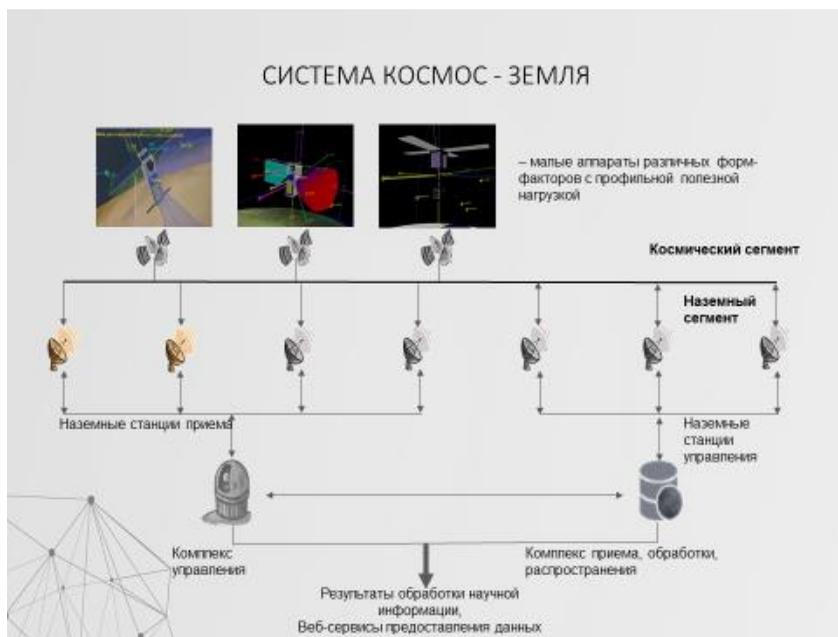
Таким образом, будет создана единая система «Космос – Земля», включающая орбитальную группировку спутников МГУ и сеть наземных приемных станций, что обеспечит оперативное управление КА, регулярный прием данных со спутников группировки, находящихся в разных точках околоземного пространства. В результате будет существенно увеличен объем передаваемой информации и оперативность ее приема вплоть до получения данных в режиме реального времени.
