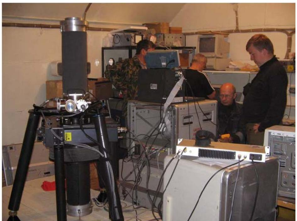
**Рис. 4.** Наблюдения абсолютным баллистическим гравиметром FG-5 (ЦНИИГАиК) на пункте подземной геодинамической Баксанской обсерватории ГАИШ МГУ.
