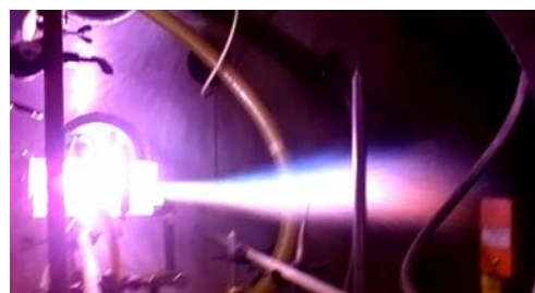
Рис. 4. Горение пропан-спирт-воздушного потока. M \leq 1 , p = 1 атм, \tau = 1 с, t_{\text{эксп}} = 20 мс.
