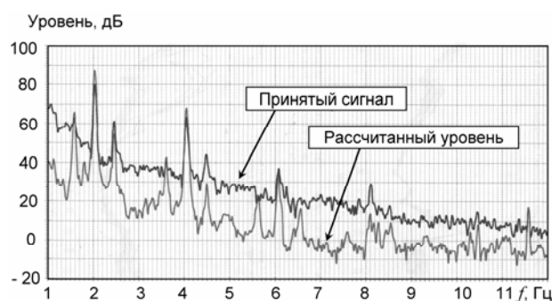
Рис.2. Сравнение уровней принятого сигнала с расчетным уровнем псевдозвукового сигнала, обусловленного вибрациями гидрофона.
