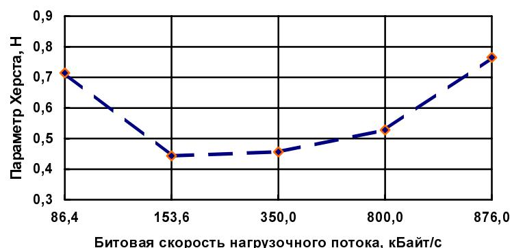
Рис. 1. Зависимость H от битовой скорости нагрузочного потока
