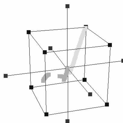
Рис. 1. Траектория движения перемещаемого атома железа в вакансию (светло-серая линия) и траектория смещения атома водорода из вакансии (темно-серая линия) в ОЦК-железе
