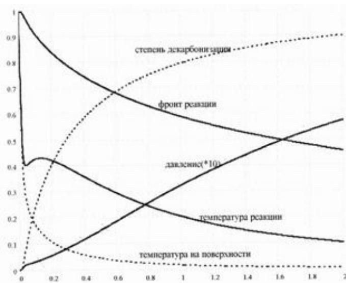
Рис.1 Зависимость параметров, характеризующих кинетику обжига  $CaCO_3$  от безразмерного времени
