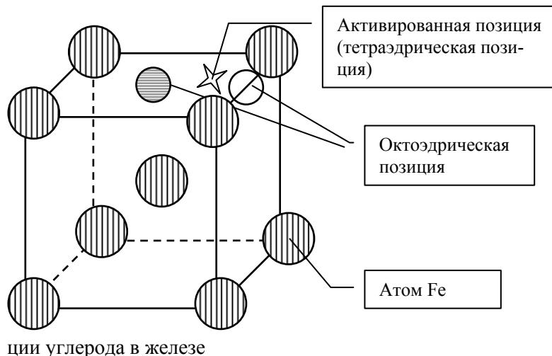
Диффузии внедренных атомов углерода в железе (см. рис. 1), происходит за счет перескока атома углерода из одной октоэдрической позиции в другую.
