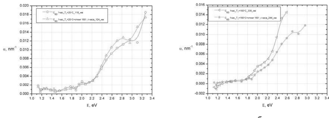
Рисунок. Спектры поглощения фуллеритовых пленок разной степени совершенства (рисунок а – для  $T_n=20^\circ\text{C}$ , б -  $T_n=160^\circ\text{C}$ ).
