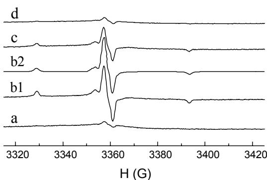
Рис. 1 Спектры ЭПР образцов TiO<sub>2</sub>, легированных азотом, полученные при температуре 300 К: *a* – в темноте, *b1* – под действием света видимого диапазона, *b2* –компьютерная симуляция экспериментального спектра *b1*, *c* – через 15 мин., *d* – через 1 час после выключения освещения.
