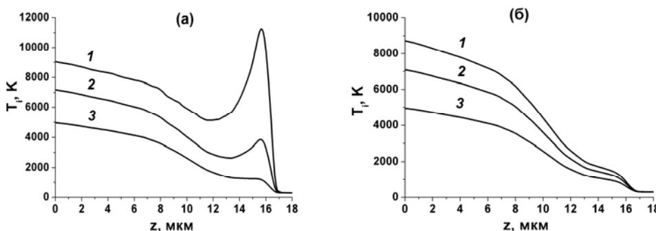
**Рис.1.** Температурные зависимости по глубине мишени в разных расстояниях от оси OZ ( $1 - r = 0$ ,  $2 - r = 25\text{\AA}$ ,  $3 - r = 50\text{\AA}$ ) с учетом потери энергии на фононы (а) и без учета (б) в момент времени  $t = 6 \times 10^{-15} \text{ с}$ .
