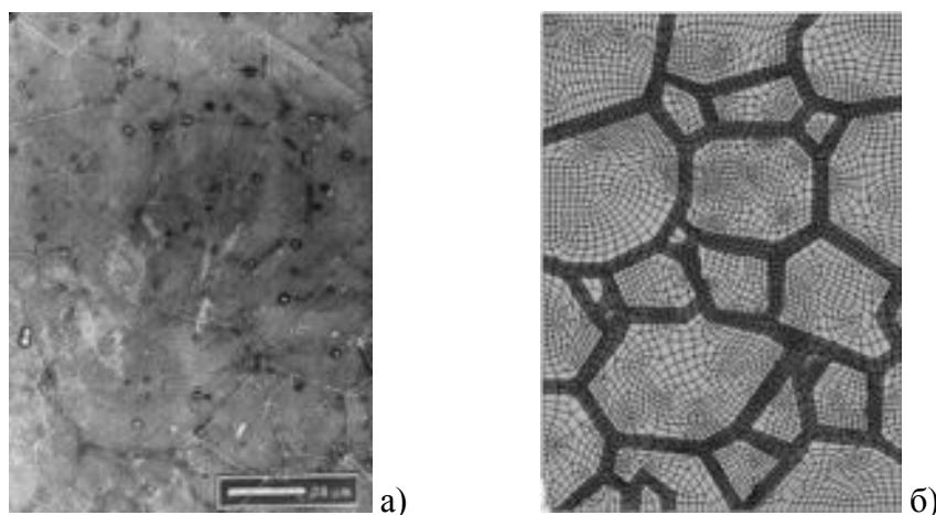
Рис. 1. Модельный образец: а) микроструктура образца  $\text{Al}_2\text{O}_3$ , б) конечно-элементная модель
