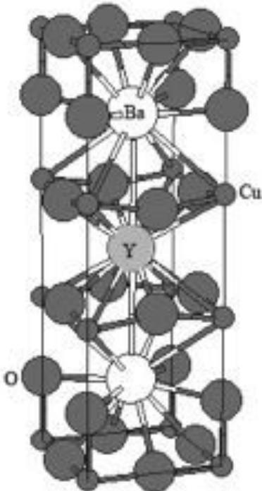
Рис.1. Элементарная ячейка ВТСП со структурой  $\text{YBa}_2\text{Cu}_3\text{O}_7$
