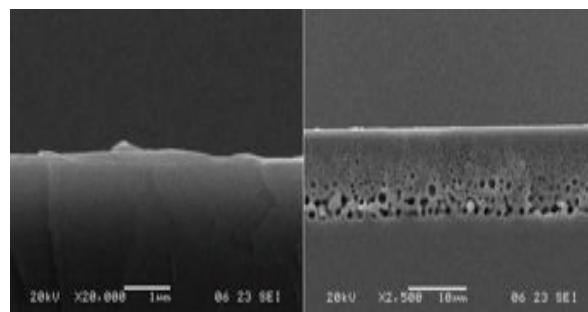
Рис. 1. Изображение поперечного скола образцов гетероструктур GaInP:Dy/GaAs
