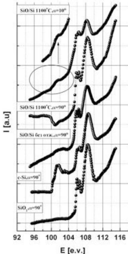
Рис. 1. Si L<sub>2,3</sub> – XANES спектры структур SiO/Si и эталонов
