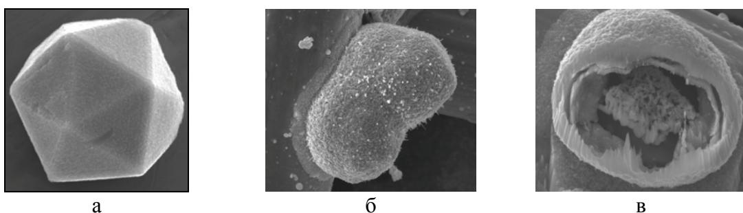
Рис. 1. а – металлическая икосаэдрическая частица после осаждения; б – частица после отжига; в – частица с внутренней полостью, разрезанной с помощью ионной пушки
