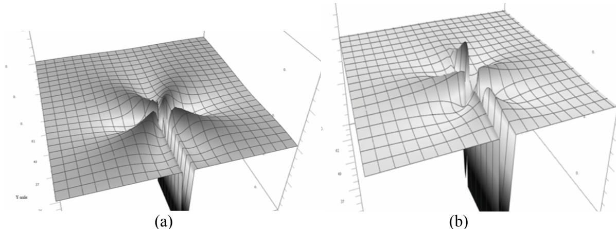
Рис. 2. Перераспределение (а) Н и (б) С в устье трещины в Fe
