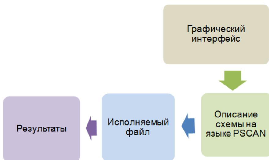
Рис. 1: Блок-схема программного комплекса PSCAN.
