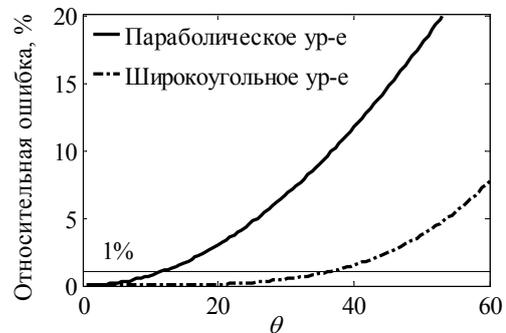
Рис.2. Относительная ошибка для фазы в решении для плоской волны в параболическом (сплошная линия) и в широкоугольном (штрихпунктирная линия) приближениях в зависимости от угла  $\theta$ .
