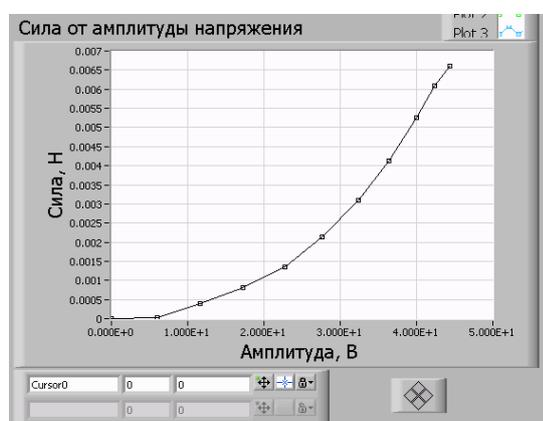
Рис.3. График зависимости силы от амплитуды напряжения при частоте 1.092 МГц
