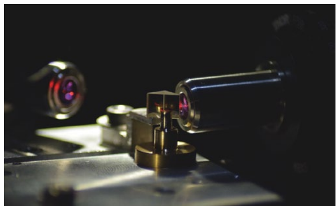
Рис. 1. Фотография микрорезонатора (маленький цилиндр перед призмой на ступенчатой подставке).
