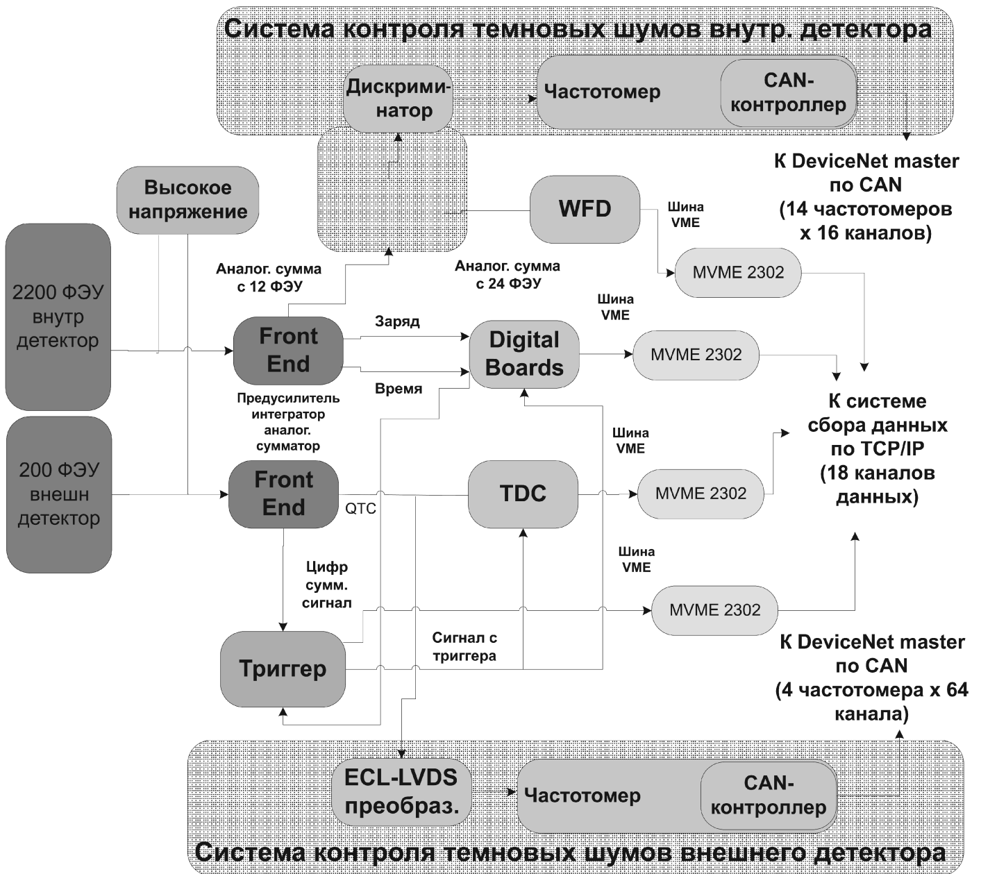
Рис. 2. Блок-схема аппаратной части системы контроля и сбора данныхorexino
